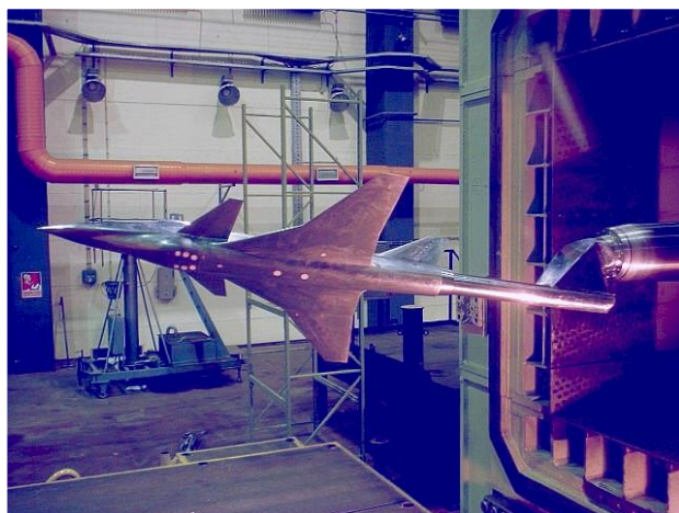
АЕРОТУНЕЛСКИ МОДЕЛ НАДЗВУЧНОГ АВИОНА У РАЗМЕРИ 1:15
