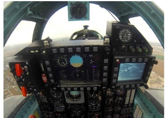
Модернизовани авион ОРАО опремљен је новим нападно навигационим системом, оптоелектронским системом, рачунарима за наоружање и мисију, дигиталним интерфејсом за комуникацију са сензорима и управљање вођеним и невођеним наоружањем.
