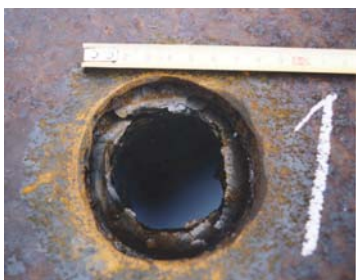
Slika 6. Efekat dejstva diska na pancirnoj ploči
