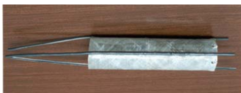
Slika 11. Sečenje komore protivgradne rakete (PGR): detonaciono sečivo dimenzija 2,90x1,85 mm; eksploziv - grafitirani heksogen linearne mase 2,95 g/m; inicijacija - detonatorskom kapislom br.8; brzina sečenja - 6650 m/s
