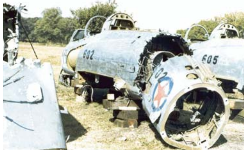
Slika 12. Sečenje aviona čiji je radni vek istekao i kod kojih se ne bi isplatio generalni remont: detonaciono sečivo - dimenzija 6,00x4,00 mm, eksploziv - grafitirani heksogen linearne mase 6,00 g/m; inicijacija - detonatorskom kapislom br.8, brzina sečenja - 7200 m/s
