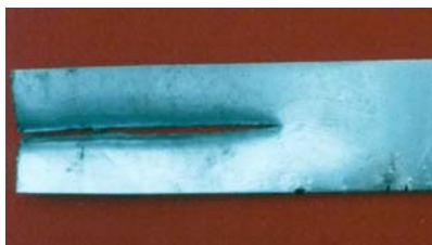
Slika 10. Sečenje čeličnog lima debljine 2,00 mm: detonaciono sečivo - dimenzija 2,40x1,50 mm, eksploziv - grafitirani heksogen linearne mase 2,20 g/m; inicijacija - detonatorskom kapislom br.8; brzina sečenja - 6400 m/s
