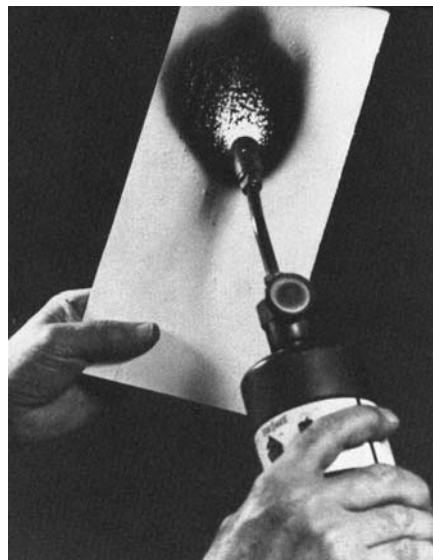
Slika 1. Jednostavna metoda ispitivanja samogasivosti premaza
