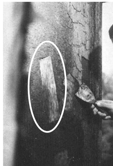
Slika 3. Izgled površine ugljenisanog premaza i podloge ispod njega (drvena podloga uokvirena na slici gotovo je netaknuta)
