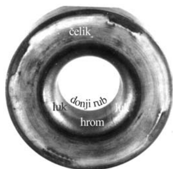
Slika 2. Makrosnimak mlaznice zaštićene prevlakom sjajnog hroma (uzorak 1, t-2), povećanje 1,3x
