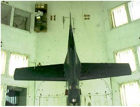
Slika 3. Postavka modela bez horizontalnog repa sa sondom u aerotunelu (pogled odozgo)
