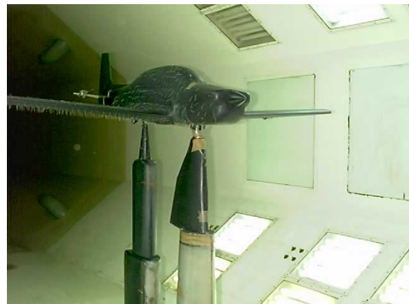
Slika 2. Postavka modela bez horizontalnog repa sa sondom u aerotunelu (pogled s prednjeg boka)
